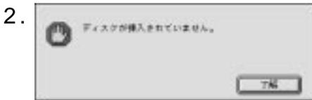
本製品に光磁気ディスクが挿入されていない状態で、操作した場合に表示されます。
