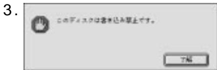
ライトプロテクトがかかった状態の光磁気ディスクを挿入しています。
